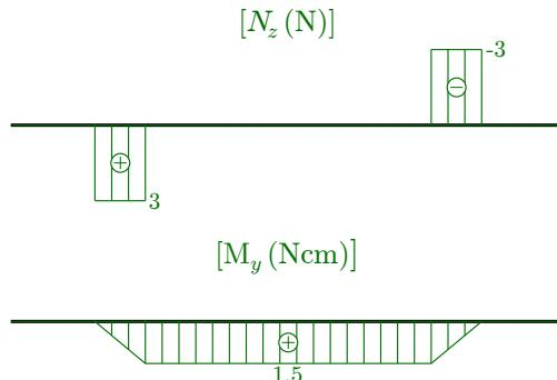
Ker je upogibni moment konstanten na celotnem delu nosilca med notranjima dvema silama, ugotovimo, da največji upogibni moment ni le na sredini nosilca.
