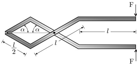
**Rešitev:** Obravnavamo le polovico klešč. Vpliv drugega dela klešč na obravnavani del zapisemo s silama  $F_1$  in  $F_0$ . Iz momentnega ravnotežnega pogoja glede na točko  $C$  lahko izračunamo silo  $F_1$ , s katero klešče delujejo na žbelj:
