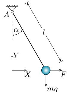
**Rešitev:** V mislih vrvico prerežemo in na prerezanem mestu predpostavimo neznano silo v vrvici  $F_v$ , kot kaže slika na desni. Zaradi 10-kilogramske uteži je vrvica obtežena z navpično silo teže  $mg = 100 \text{ N}$ .
