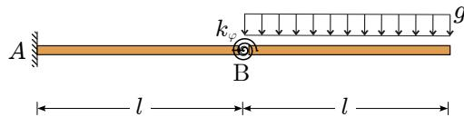
Desni del nosilca je obtežen s slediščno enakomerno obtežbo  $g$ . Kot vemo, taka obtežba sledi obračanju nosilca.
