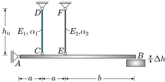
**Rešitev:** Jeklena palica  $CD$  se segreje za  $33^\circ\text{C}$ , dolžina palice se poveča za
