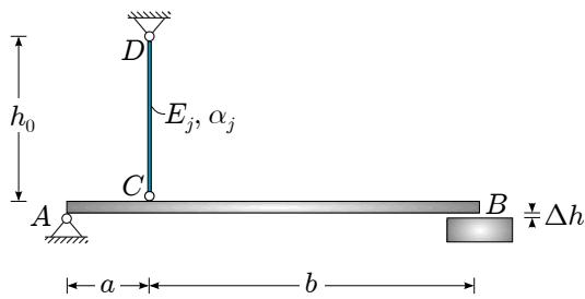
**Rešitev:** Ko palico segrejemo, se nosilec zavrti kot togo telo okoli točke  $A$ . Pri določeni temperaturi je zasuk tak, da se nosilec dotakne toge podlage v točki  $B$ . Ob tolikšnem zasuku nosilca se točka  $C$  v navpični smeri premakne za  $w_C = 0.0008 \text{ m}$  (glej spodnjo sliko).
