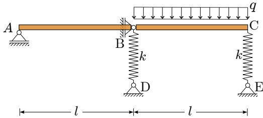
Izračunajte sile v vzmeterih in narišite deformirano lego nosilca. Izračunajte tudi vodoravni pomik točke  $A$  in to upoštevajte pri risbi deformirane lege. Določite notranje sile v nosilcu in narišite njihove diagrame.
