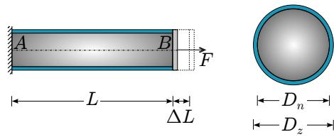
V analizi upoštevajte, da je nosilec na robu  $B$  zaključen s togo ploščo. Izračunajte tudi raztezek sovprežnega nosilca  $\Delta L$ .
