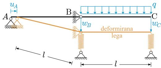
Notranje sile v konstrukciji prikazujemo na spodnjih diagramih. Levi del konstrukcije je neobremenjen, zato so tam notranje sile enake nič, desni del je prostoležec nosilec.
