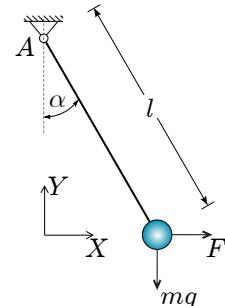
**Rešitev:** Vrvico prerezemo in v prerezu predpostavimo silo v vrvici  $F_v$ . Na utež delujejo sila vrvice  $F_v$ , sila teže  $mg = 100 \text{ N}$  in sila  $F$ , s katero vlecemo utež iz navpične lege. Zapišimo ravnotežni pogoj v navpični smeri in iz njega izračunamo silo v vrvici:
