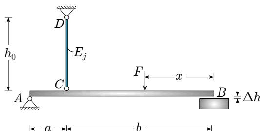
Ker je nosilec  $AB$  tog, deformacij v nosilcu ni, v analizi pa morate upoštevati deformabilnost jeklene palice  $CD$  s premerom  $d = 1 \text{ cm}$ .
