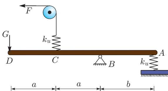
**Rešitev:** Sistem teles razstavimo, kot kaže slika, medsebojne vplive pa ob predpostavki majhnih zasukov opišemo z ustreznimi silami. Neznane sile določimo z reševanjem ravnotežnih enačb glede na začetno lego. Sila v vrvi  $F_v$  je enaka sili  $F$ , silo v vzmeti  $A_Z$  pa določimo iz momentnega ravnotežnega pogoja za nosilec glede na točko  $B$ :
