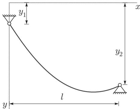
**Rešitev:** Za vodnik smo predpostavili, da je neraztegljiv, zato se njegova lega s povečanjem porazdeljene obtežbe ne spreminja. Za rešitev naloge tako zadošča že, če določimo lego vodnika v poljubni vmesni točki. Izberimo kar točko  $l/2$ :
