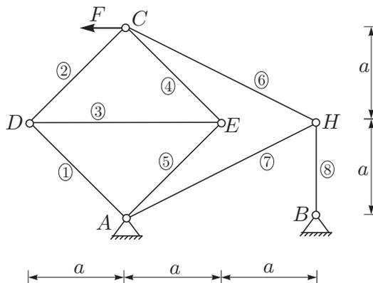
**Rešitev:** V vseh vozliščih paličja razen v vozlišču  $B$  se stikajo po tri palice. Zato naprej izrežemo vozlišče  $B$  in iz dveh ravnotežnih enačb izračunamo:  $B_X = 0$  in  $N_8 = B_Z$ . Preostale tri neznane reakcije določimo iz ravnotežnih pogojev za celotno konstrukcijo
