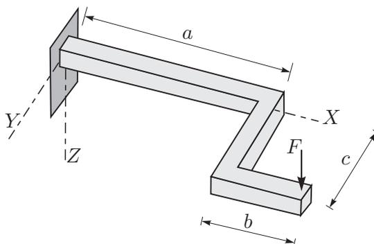
**Rešitev:** Medsebojni vpliv med kljuko in steno opisuje sistem šestih komponent sil in momentov. Kljuko odstranimo, njen vpliv na steno pa nadomestimo s komponentami sil in momentov:
