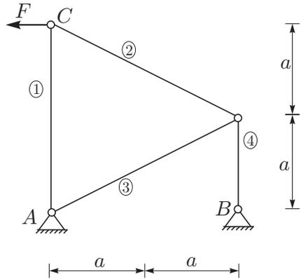
**Rešitev:** Nalogo rešimo z metodo izrezovanja vozlišč. Vpliv palic in podpor nadomestimo z ustreznimi silami, kot kaže slika. Za vsako vozlišče zapišemo dve ravnotežni enačbi:
