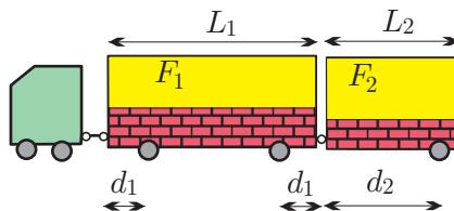
**Rešitev:** Statični model prikolic prikazujemo na spodnji sliki. Model sestavlja dva členkasto povezana nosilca, podprtih v treh oseh, ki so na sliki označene s tremi silami podpor  $A$ ,  $B$  in  $C$ .
