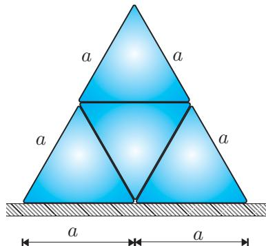
**Rešitev:** Sistem štirih prizem razstavimo na tri podsisteme, kot kaže slika. Skladno s 3. Newtonovim zakonom medsebojne vplive ter vpliv podlage nadomestimo s silami. Nato za vse tri podsisteme zapišemo ravnotežne pogoje v vodoravni in navpični smeri.
