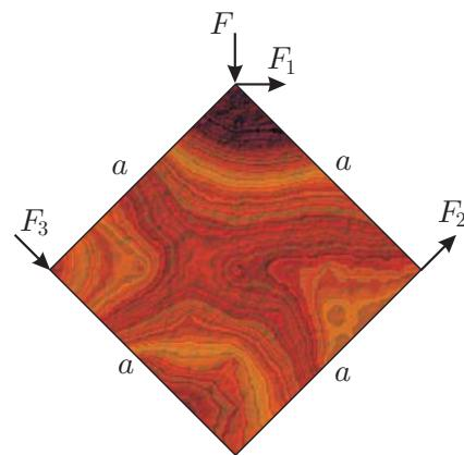
**Rešitev:** Zapišemo momentne ravnotežne pogoje glede na točke  $A$ ,  $B$  in  $C$  (glej spodnjo sliko) in iz dobljenih enačb izračunamo neznane sile  $F_1$ ,  $F_2$  in  $F_3$ :
