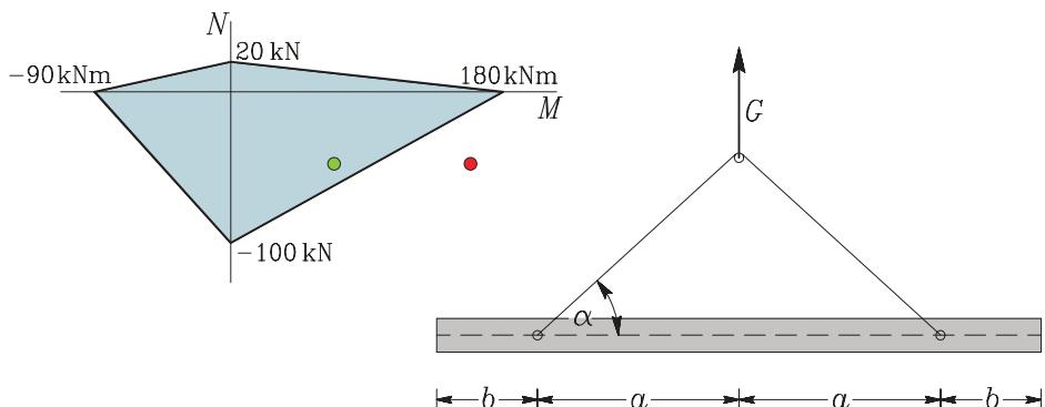
**Rešitev:** Kritična prereza, ki ju bomo morali preveriti sta na sredini armiranobetonskega nosilca in ob vpetju vrvi. Izračunajmo najprej reakcije nosilca, nato pa še notranje sile (osno silo in upogibni moment) na sredini nosilca in ob vpetju:
