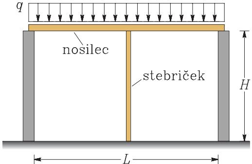
V pomoč naj ti bosta enačbi za določitev povesa na sredini prostoležečega nosilca pri enakomerni linijski obtežbi  $w_q$  in točkovni sili na sredini razpona nosilca  $w_F$ :
