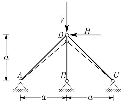
**Rešitev:** Nalogo rešujemo podobno kot 3. nalogo na predtekmovanju. V naslednji preglednici zapišemo spremenjene dolžine palic, specifične deformacije in osne sile v palicah.
