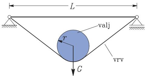
**Rešitev:** V mislih prerežemo vrvi in na mestu prereza predpostavimo silo v vrvi. Tik ob podpori prerežemo tudi nosilec in predpostavimo notranji sili  $N_x$  in  $N_z$ . Iz ravnotežnih pogojev za celotno konstrukcijo v vodoravni smeri ugotovimo, da je vodoravna reakcija prostoležečega nosilca enaka nič.
