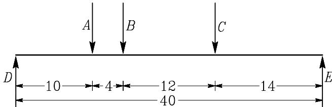
Ker na nosilec delujejo le točkovne sile, je upogibni moment odsekoma linearna funkcija. Zato je dovolj, da izračunamo upogibne momente v značilnih točkah nosilca (pri  $x = 10 \text{ m}$ ,  $x = 14 \text{ m}$  in  $x = 26 \text{ m}$ ). V obeh podporah prostoležečega nosilca sta upogibna momenta seveda enaka nič.
