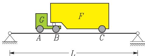
**Rešitev:** Preden lahko izračunamo notranje sile v prostoležečem nosilcu, moramo določiti, kolikšne so sile v vseh treh oseh tovornjaka. Konstrukcijo tovornjaka sestavlja dva povezana nosilca, kar je prikazano na naslednji sliki.
