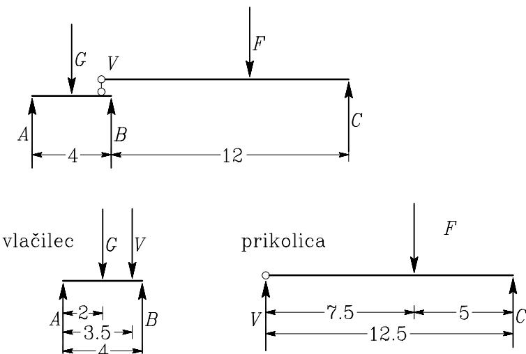
Nosilca ločimo in vez nadomestimo s silo v vezi  $V$ . Iz ravnotežnih pogojev za vlačilec in prikolico, lahko izračunamo sile  $A$ ,  $B$  in  $C$  v oseh tovornjaka ter silo v vezi  $V$ . Zapišimo najprej ravnotežne enačbe za prikolico:
