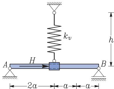
**Rešitev:** Ločeno narišimo dva dela konstrukcije v deformirani legi, ko se vodilo premakne v desno. Pri tem je pomembno, da narišemo vse sile, ki na oba dela konstrukcije delujejo. Pri tem upoštevamo, da med vodilom in nosilcem ni trenja. Zato se z vodila na nosilec in obratno prenaša le navpična sila  $F$ . V deformirani legi je naklon vzmeti  $\alpha$ :
