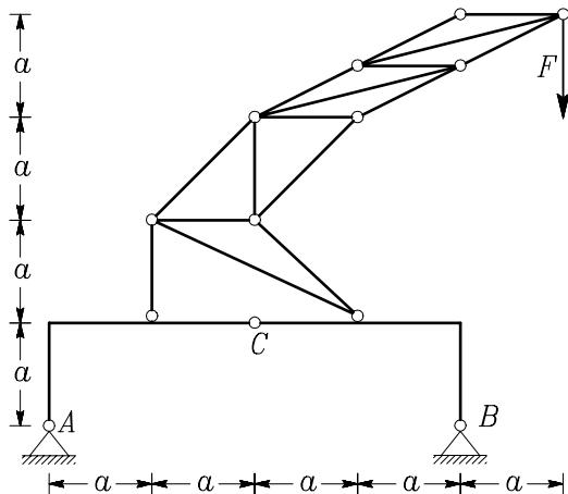
**Rešitev:** Konstrukcijo razdelimo na paličje in tročlenski okvir, kot kaže slika. Reakcije paličja predstavljajo obtežbo na tročlenski okvir.
