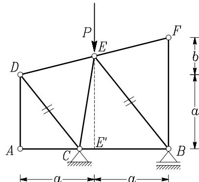
**Rešitev:** Nalogo najlažje rešimo tako, da konstrukcijo prerežemo na dva dela tako, kot kaže spodnja slika. Nato zapišemo momentno ravnotežno enačbo glede na točko  $O$  za levi del konstrukcije. V tej enačbi nastopata le neznana sila  $N_{AC}$ , ki jo iščemo, in reakcija  $C_Y$ .
