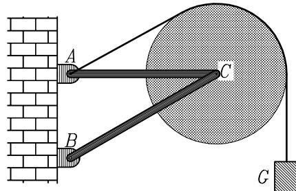
**Rešitev:** Konstrukcijo razstavimo na tri dele (glej sliko pri 3. nalogi za 3. letnike): škripcev, podpora  $A$  in podpora  $B$ , nato zapišemo za vsak del konstrukcije po dve ravnotežni enačbi. Ravnotežni enačbi za izrezani del s škripcem sta:
