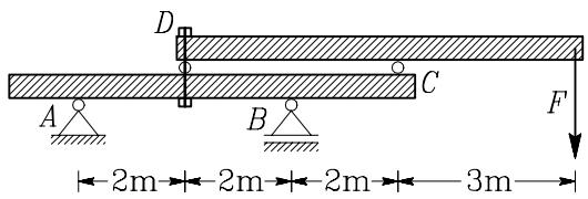
**Rešitev:** Ker v vodoravni smeri ni nobene obtežbe, vodoravne reakcije za prikazano konstrukcijo ni. Silo v vijaku  $D$  in silo v vezi  $C$  izračunamo iz momentnih ravnotežnih pogojev na točki  $C$  in  $D$  za zgornji nosilec (glej sliko):
