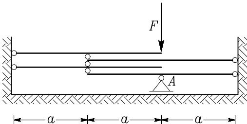
**Rešitev:** Konstrukcijo razstavimo na dele tako, kot je prikazano na sliki. V vezeh in podporah predpostavimo neznane sile  $A, \dots, I$ . Iz ravnotežnih pogojev za posamezne dele izračunamo sile v vezeh in reakcije v podporah:
