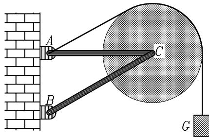
**Rešitev:** Konstrukcijo razstavimo na tri dele (glej sliko): škripec, podpora  $A$  in podpora  $B$ , nato zapišemo za vsak del konstrukcije po dve ravnotežni enačbi. Ravnotežni enačbi za del s škripcem sta:
