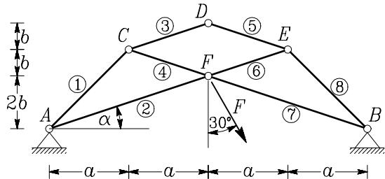
**Rešitev:** Iz ravnotežja sil v vozliščih  $C$ ,  $D$  in  $E$  sledi, da so sile v palicah 1, 3, 4, 5, 6 in 8 enake nič.
