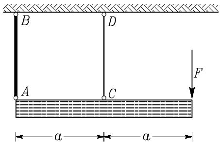
Se konstrukcija poruši zato, ker popusti vrv, ali zato, ker se ukloni nosilec? Določi tudi lego sile  $F$  tako, da bosta vrv in nosilec popustila istočasno. Razdalja  $a = 3$  m.
