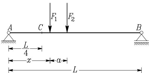
**Rešitev:** Predvidevamo lahko, da bo največji moment takrat, ko bo ena ali druga sila delovala v točki  $C$ . Zato izračunamo momenta za ti dve legi sil: za  $x = 1 \text{ m}$  in za  $x = 4 \text{ m}$ . Za oba primera izračunamo reakcijo v podpori  $A$  in upogibni moment v točki  $C$ .
