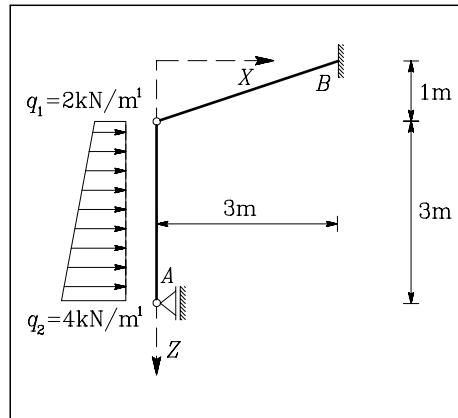
**Rešitev:** Vodoravna reakcija v točki A je  $A_X = -5 \text{ kN}$ , vodoravna reakcija v točki B pa  $B_X = -4 \text{ kN}$ . Navpična reakcija v točki B je enaka nič, moment v točki B pa je enak  $M_B = -4 \text{ kNm}$ . Osna sila je od nič različna le v poševnem nosilcu, kjer je konstantna  $N_x = -3.8 \text{ kN}$ . Prečne sile in upogibni momenti so prikazani v diagramu.
