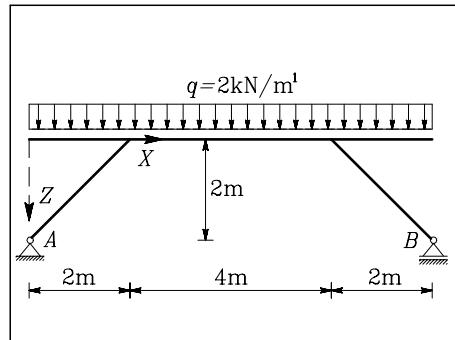
**Rešitev:** Navpični reakciji sta v obeh podporah enaki  $A_Z = B_Z = -8 \text{ kN}$ . Vodoravna reakcija v levi podpori je enaka nič. Osna sila je od nič različna le v poševnih nosilcih ( $N_x = -5.66 \text{ kN}$  (tlak)). Prečne sile in upogibni momenti so prikazani v diagramih.
