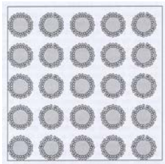
Slika 1: Tvorba mejne plasti v nanofluidih
