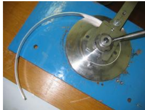
Slika 6. Drugo nadaljevalno krivljenje nosilca na radij orodja r_0 = 60 mm. Začetni radij: R_z = 166 mm
