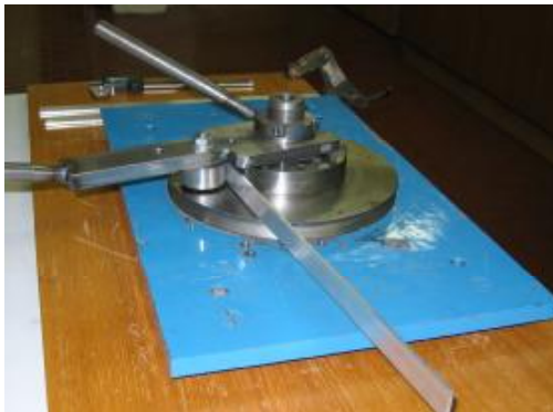
Slika 5. Krivljenje nosilcev pravokotnega prereza z ravno osjo na radij orodja r_0 = 110 mm Začetni radij: R_z = \infty mm
