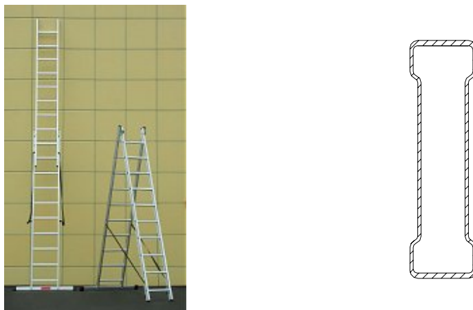
Slika 1: Tehnične lestve (levo) in prerez njihovega nosilnega profila (desno)
