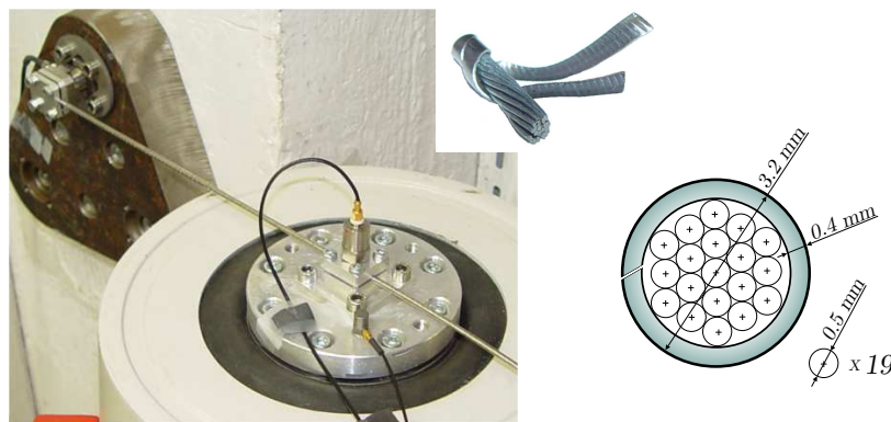
Slika 3 : Merilni sistem in geometrijski podatki za pletenico.
