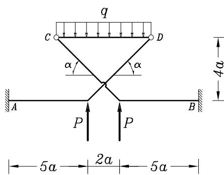
**NALOGA 8.** Z Maxwellovim izrekom izračunaj vplivnici za reakcijo in upogibni moment v točki  $B$  za prikazani kontinuirni nosilec.
