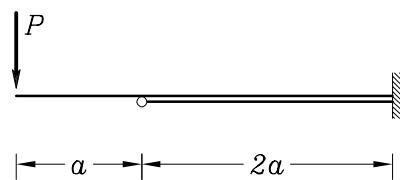
**NALOGA 2.** Določi moment  $X$  tako, da bo funkcija zasukov  $\varphi$  zvezna po celotni dolžini prikazanega kontinuirnega nosilca. Izračunaj tudi reakcije in nariši diagramne notranjih sil.
