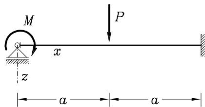
**NALOGA 7.** Za prikazani kontinuirni nosilec izračunaj reakcije in notranje sile  $N_x$ ,  $N_z$  in  $M_y$  ter zasuk na mestu in v smeri enega od momentov  $M$ . Pri izračunu upoštevaj simetrijo konstrukcije.
