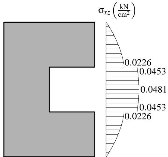
3. Osne sile so enake nič. Diagrami preostalih notranjih sil za silo  $F = 1$  kN so prikazani na spodnjih slikah.
