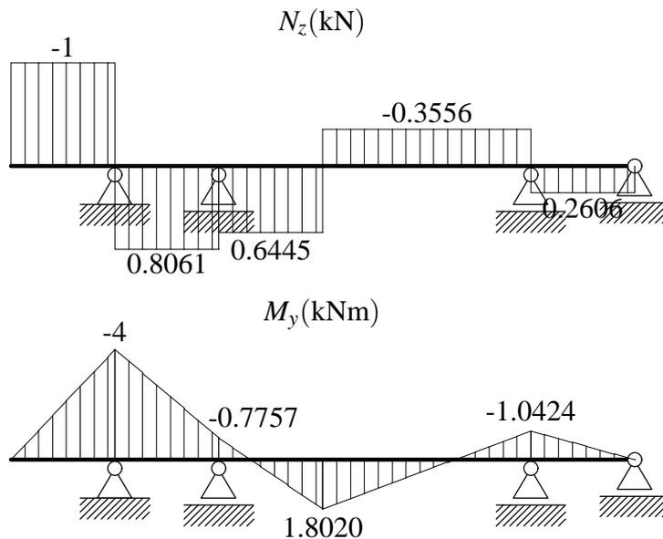
Iz slike je razvidno, da se bo prvi plastični členek pojavil nad skrajno levo podporo. Od tu iz porušnega mehanizma (na spodnji sliki) določimo porušno obtežbo  $F^\bullet = \frac{M_p}{a} = 50$  kN.
