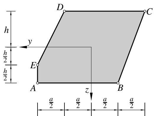
3. Ravninski mreža je obremenjena z navpično silo  $F$ . Vsi nosilci imajo enak prerez, kakršen je prikazan na sliki. Vse stene so enake debeline  $t = 1 \text{ cm}$ . Izračunaj upogibni in torzijski vztrajnostni moment prerezova. Izračunaj notranje sile in nariši diagrame notranjih sil.
