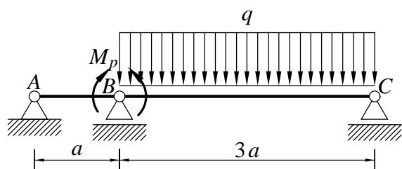
3. Konstrukcija je enkrat statično nedoločena. Diagrame notranjih sil prikazuje spodnja slika.
