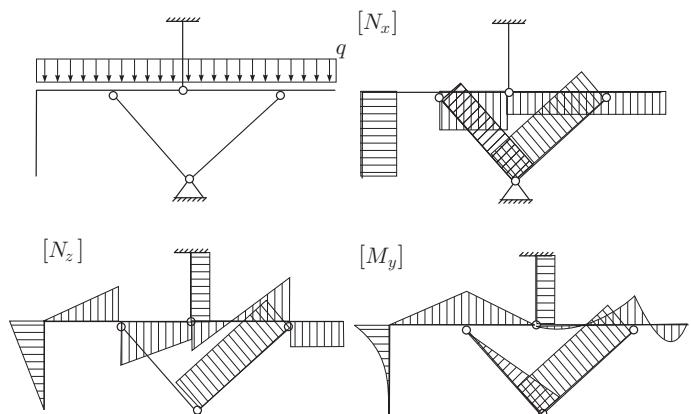
3. Za palično konstrukcijo na sliki izračunajte stopnjo statične nedoločenosti, reakcije in osne sile v označenih palicah! (20%)
