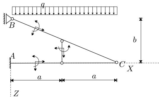
3. Za palično konstrukcijo na sliki izračunajte stopnjo statične nedoločenosti in osne sile v palicah 1, 2 in 3! (30%)
