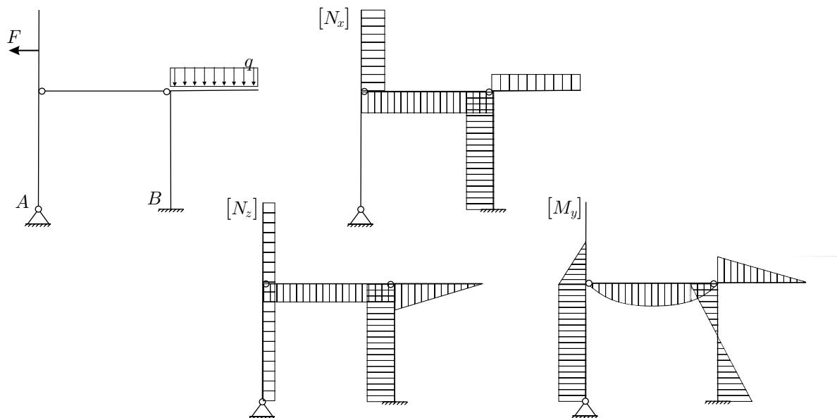
2. Za konstrukcijo na sliki izračunajte stopnjo statične nedoločenosti, reakcije in notranje statične količine ( $N_x, N_z, M_y$ )! Rezultate notranjih statičnih količin prikažite z diagrami!
