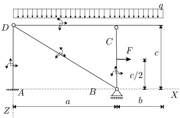
3. S principom virtualnega dela za konstrukcijo na sliki izračunajte reakcije v podporah in notranji moment v točki B –  $M_B$ ! (25%)
