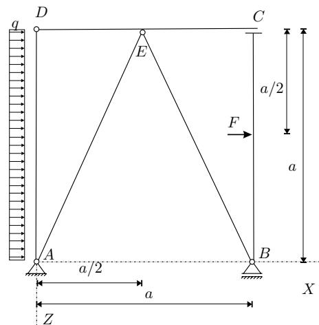
3. S principom virtualnega dela za konstrukcijo na sliki izračunajte reakcije v podporah in notranji moment v točki  $B$  –  $M_B$ ! (25%)
