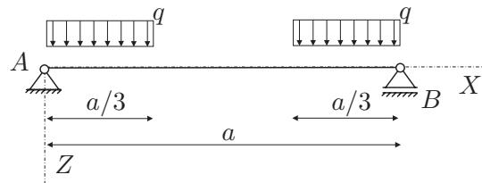
2. Za konstrukcijo na sliki izračunajte stopnjo statične nedoločenosti, reakcije in notranje statične količine ( $N_x, N_z, M_y$ )! Rezultate notranjih statičnih količin prikažite z diagrami!
