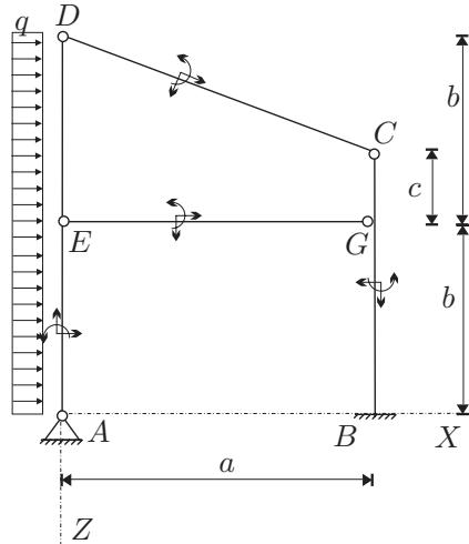
3. Za palično konstrukcijo na sliki izračunajte stopnjo statične nedoločenosti in osne sile v palicah 1, 2 in 3! (30%)
