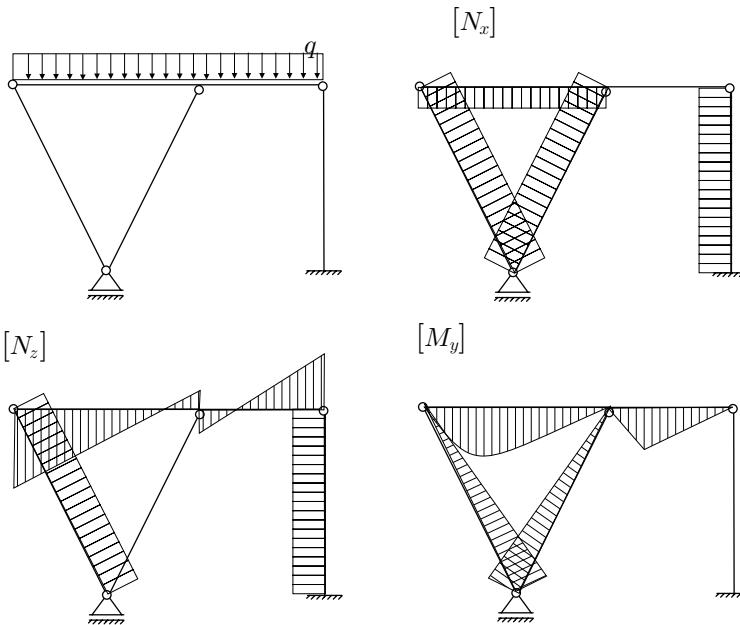
2. Za konstrukcijo na sliki izračunajte stopnjo statične nedoločenosti, reakcije in notranje statične količine ( $N_x, N_z, M_y$ )! Rezultate notranjih statičnih količin prikažite z diagrami!
