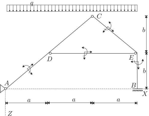
2. Za palično konstrukcijo na sliki izračunajte stopnjo statične nedoločnosti in osne sile v palicah 1, 2 in 3! (30%)
