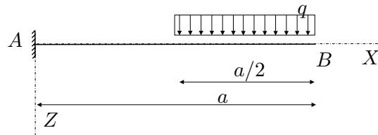
2. Za konstrukcijo na sliki izračunajte stopnjo statične nedoločenosti, reakcije in notranje statične količine ( $N_x, N_z, M_y$ )! Rezultate notranjih statičnih količin prikažite z diagrami!
