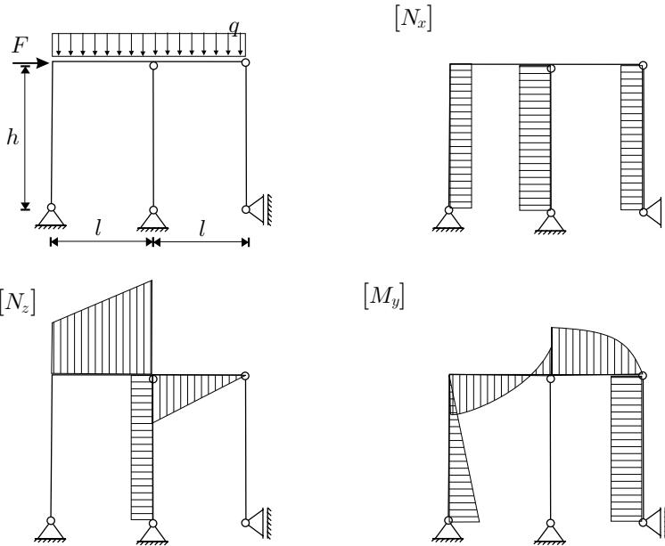
2. Za konstrukcijo na sliki izračunajte stopnjo statične nedoločenosti, reakcije in notranje statične količine ( $N_x, N_z, M_y$ )! Rezultate notranjih statičnih količin prikažite z diagrami!
