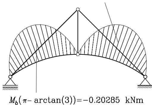
3. (35 %) Z izrekom o virtualnem delu določi prečno silo in upogibni moment v točki  $T$ . Moment  $M$  prijelje v vezi, ki dopušča le medsebojni pomik levega in desnega dela konstrukcije v horizontalni smeri.
