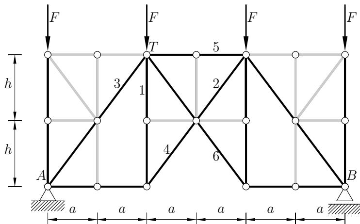
2. Z uporabo ravnotežnih enačb izračunamo reakcije  $A_x = 0$ ,  $A_z = 0$  in  $B_z = -2qa = -12$  kN. Po metodi izrezovanja vozlišč določimo osne sile v palicah in nato z uporabo ravnotežnih enačb še notranje sile v gredi. Diagrame notranjih sil prikazuje spodnja slika.
