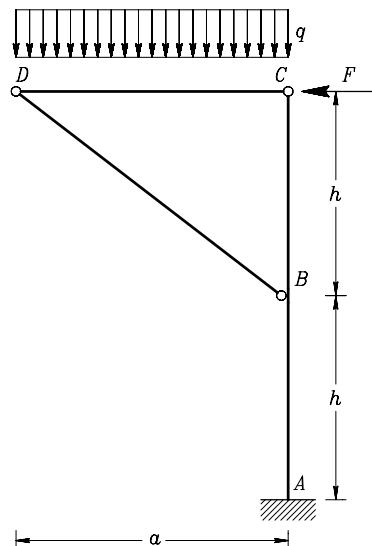
4. Z uporabo izreka o virtualnem delu izračunaj prečno silo  $N_z$  in upogibni moment  $M_y$  na sredini nosilca  $AB$ .
