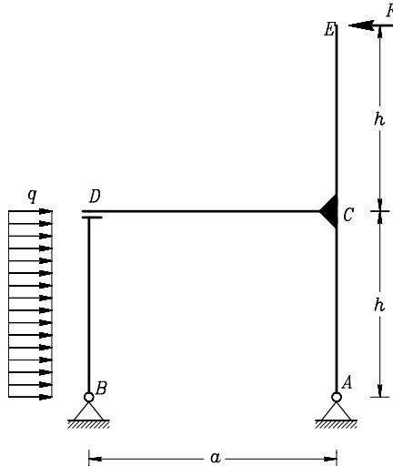
3. Ravninski okvir na sliki je obremenjen z zvezno obtežbo  $q$  in vodoravno silo  $F$ , kot prikazuje slika. Izračunaj računsko število prostostnih stopenj  $\tilde{n}_{ps}$ , reakcije, notranje sile in nariši diagrame notranjih sil.
