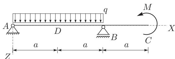
4. Za konstrukcijo na sliki izračunajte notranje momente po metodi sil! Pri upogibno obremenjenih nosilcih upoštevajte samo vpliv upogibnih momentov na deformiranje. (30%)
