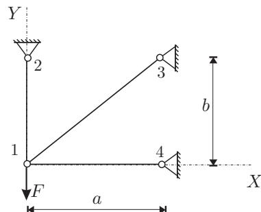
3. Za konstrukcijo na sliki izračunajte notranje statične količine in zasuk v točki  $A$ ! Vpliva osnih in prečnih sil ni potrebno upoštevati.
