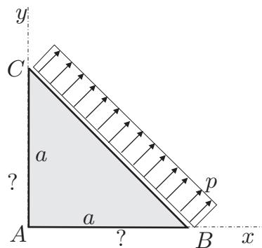
2. Za paliče na sliki določite pomike vozlišč in notranje sile v palicah po metodi pomikov! (25%)
