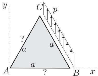
2. Prerez na sliki je obremenjen s prečno silo  $N_z = 10 \text{ kN}$ . Določite nekaj značilnih vrednosti in skicirajte diagrama strižnih napetosti  $\sigma_{xy}$  in  $\sigma_{xz}$  v tem prerezu! (25%)
