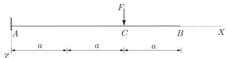
4. Za konstrukcijo na sliki izračunajte notranje momente po metodi sil! Pri upogibno obremenjenih nosilcih upoštevajte samo vpliv upogibnih momentov na deformiranje. (25%)
