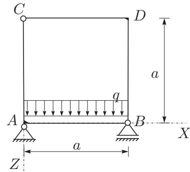
4. Za statično nedoločeno konstrukcijo na sliki določite navpična pomika v točkah  $C$  in  $D$ ! (20%)
