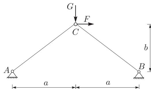
4. Za statično nedoločeno konstrukcijo na sliki izračunajte notranje statične količine! (25%)
