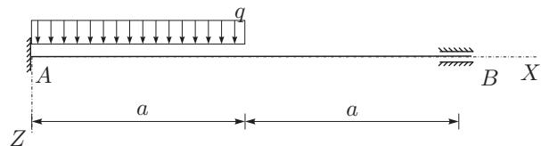
4. Za konstrukcijo na sliki izračunajte notranje statične količine po metodi sil! Pri upogibno obremenjenih nosilcih upoštevajte samo vpliv upogibnih momentov na deformiranje. (OBVEZNA NALOGA 50%)
