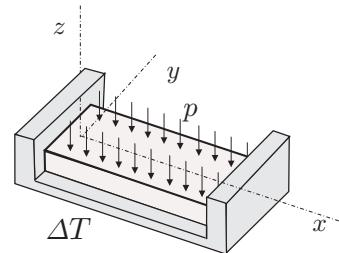
2. Prerez na sliki je obremenjen s prečno silo  $N_z = 10 \text{ kN}$  in upogibnim momentom  $M_y = 5 \text{ kNm}$ . Določite in narišite potek normalnih napetosti  $\sigma_{xx}$  in strižnih napetosti  $\sigma_{xy}$  po prerezu! (25%)
