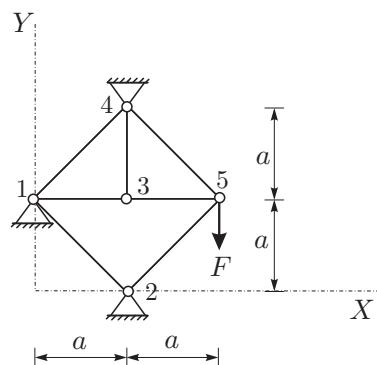
4. Za statično nedoločeno konstrukcijo na sliki izrazite notranje sile in določite navpični pomik na sredini razpona! Rezultate notranjih statičnih količin prikažite z diagrami! (25%)
