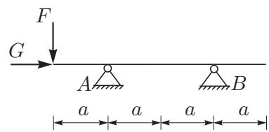
4. Za konstrukcijo na sliki izračunajte notranje statične količine po metodi sil! Vpliva osnih in prečnih sil ni potrebno upoštevati. (30%)
