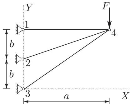
4. Za konstrukcijo na sliki izračunajte notranje statične količine po metodi sil! (25%)
