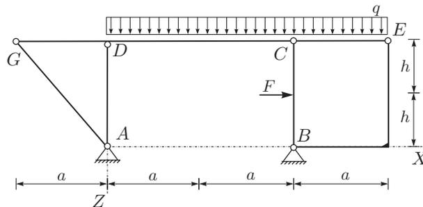
3. S principom virtualnega dela za konstrukcijo na sliki izrazite reakcije v podporah in notranji moment v točki D! (20%)
