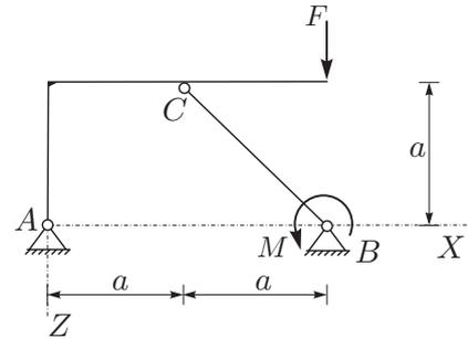
2. **OBVEZNA NALOGA:** Za konstrukcijo na sliki izračunajte stopnjo statične nedoločenosti, reakcije in notranje statične količine ( $N_x, N_z, M_y$ )! Rezultate notranjih statičnih količin prikažite z diagrami! (55%)
