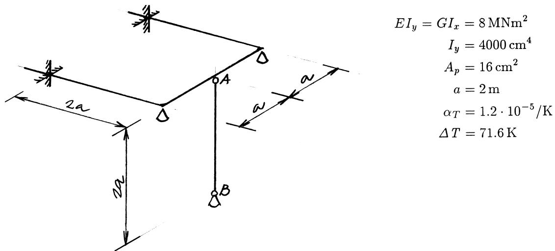
**Rešitev:** Osna sila v palici  $AB$  je  $N_{AB} = \frac{16\alpha TE A_p I_y}{a^2 A_p + 16 I_u} \Delta T = 25 \text{ kN}$ .
