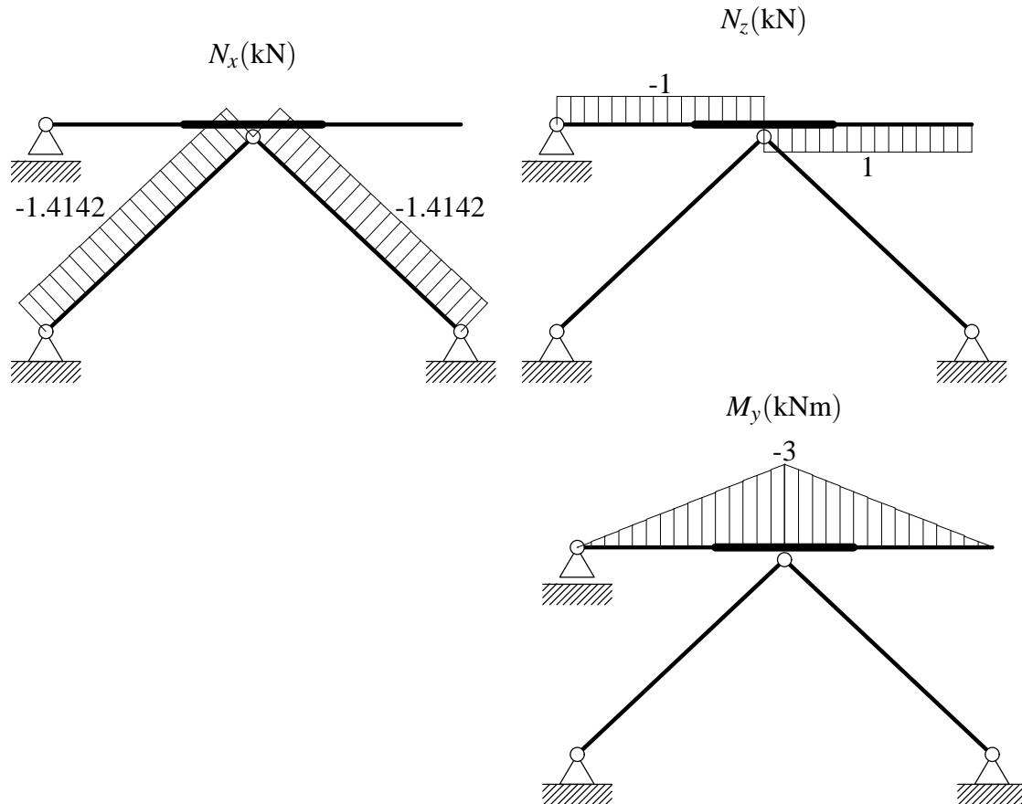
Pri računu pomikov konstrukcijo razrežemo na nosilec in paličje (glej sliko spodaj). Z uporabo diferencialnih enačb nosilca in metode pomikov (paličje) določimo navpični in vodoravni pomik vozlišča  $G$ , nato pa še navpični in vodoravni pomik prostega krajišča nosilca.
