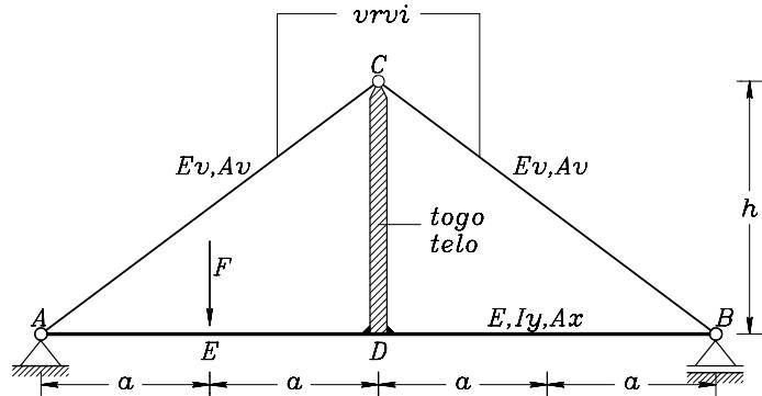
3. Za prikazano ravninsko mrežo izračunaj reakcije v podporah in notranje sile ter nariši diagrame notranjih sil. V točki  $A$  je viličasta podpora (viličasta podpora preprečuje vse pomike in zasuk v smeri osi nosilca (torzijski zasuk), dopušča pa preostala upogibna zasuka). Izračunaj tudi navpični pomik točke  $E$ .
