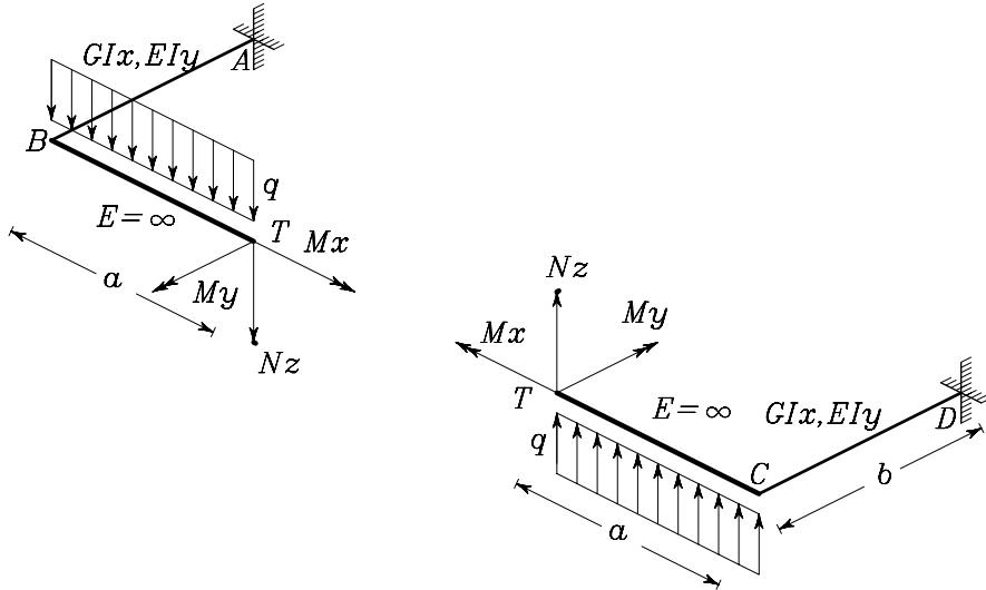
Če upoštevamo antisimetrijo obtežbe lahko obravnavamo samo polovico konstrukcije npr. del  $ABT$ . Mi tega ne bomo naredili. Notranje sile bomo izračunali tako kot bi jih izračunali pri poljubni pravokotni obtežbi. V točki  $T$  morata biti enaka zasuka okrog osi  $x$  in  $y$  kot tudi vertikalni pomik  $w$  levega in desnega dela konstrukcije. Označimo del konstrukcije  $ABT$  z 1 in del  $TCD$  z 2. Potem lahko pogoje matematično zapišemo z enačbami
