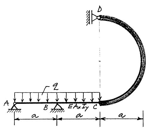
Lahek fasadni element  $\overline{CD}$  je zelo tog v primerjavi z nosilcem  $\overline{AC}$ . V točki C sta oba dela konstrukcije togo povezana. Določi navpični pomik točke D v odvisnosti od velikosti zvezne obtežbe  $q$ !
