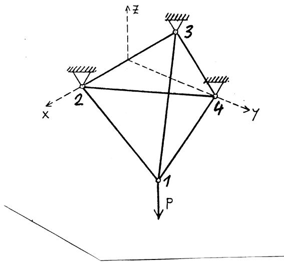
Vse palice prikazanega paličja imajo enake dolžine  $a$  in enake prečne prereze  $A$ . Določi napetosti v palici  $\overline{12}$  in vektor pomika vozlišča 1 glede na koordinatni sistem  $(x, y, z)$ .
