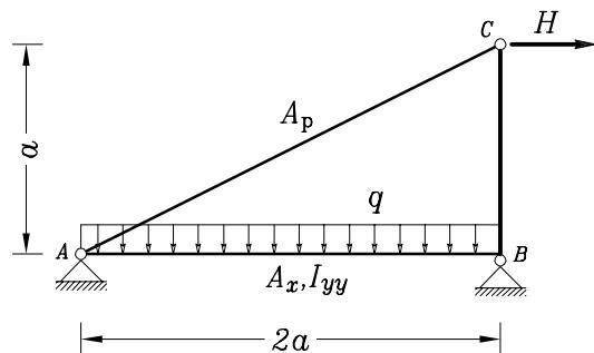
**NALOGA 3.** Določi osno silo v palici  $BC$ , če konstrukcijo enakomerno ohladimo za  $\Delta T = -90$  K. Kolikšen je pomik v točki  $C$ ?
